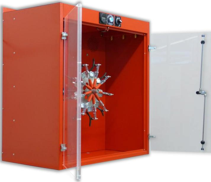
Unser Maskentrockenschrank MTS 1800 New gewährleistet durch das ständige Drehen der Atemschutzmasken auf dem integrierten Drehteller eine effiziente und schonende Warmluftgebläse-Trocknung, so dass die Trockenzeit nur ca. 15 bis 30 Minuten beträgt. Durch das schnelle und einfache Klemmverfahren am Sichtglas eignet sich der Maskentrockenschrank für alle Maskentypen.
